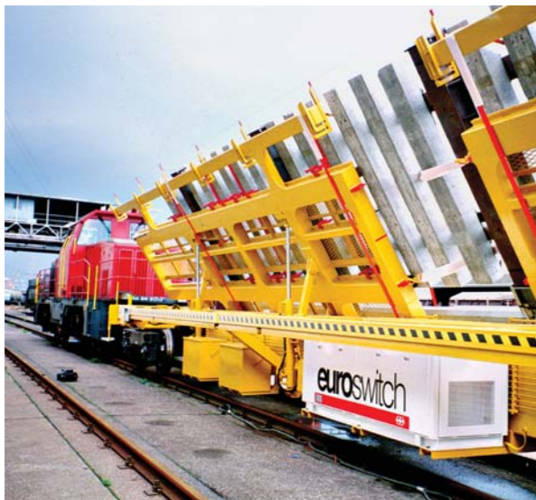
Prefabbricazione esterna degli scambi.
