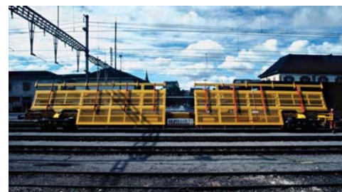
Pré-montage externe des appareils de voie
